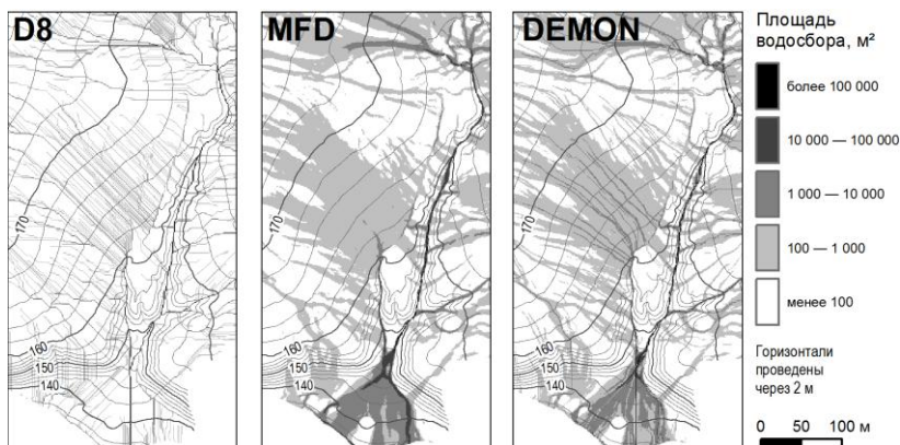
Рис. 1. Результат расчёта площади водосбора по ЦМР с использованием алгоритмов D8, MFD и DEMON (фрагмент)
